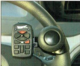
▲ Boule fixée au volant à droite ou à gauche avec commandes principales
